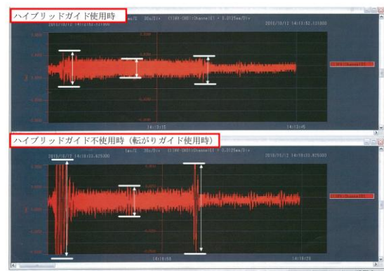
上段：ハイブリッドガイド使用時の振動データ 下段：ハイブリッドガイド不使用時の振動データ
